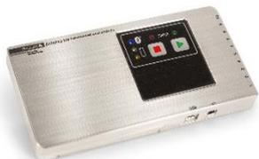
**TP6100** - 10 entrées de thermocouple et compatibilité avec la plus large gamme de barrières thermiques (y compris notre gamme étanche pour zone de trempe eau). Il peut être commandé avec un mixte de types de thermocouples ainsi qu'avec un émetteur radio fournissant les données de profilage en temps réel.
