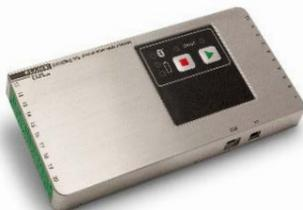
**TP6200** - TP6200 - 20 entrées de thermocouple et compatibilité avec la plupart des barrières thermiques conventionnelles. Il peut être commandé avec un maximum de quatre entrées analogiques et un mixte de types de thermocouples, ce qui en fait le meilleur choix pour les applications de profilage les plus complexes.
