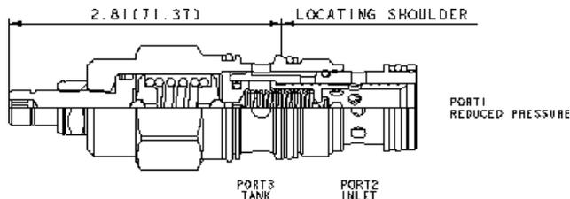
Dieses vorgesteuerte 3-Wege-Druckregelventil reduziert einen hohen Primärdruck an Anschluss 2 auf einen niedrigeren, geregelten Druck an Anschluss 1. Überdruck an Anschluss 1 wird über Anschluss 3 zum Tank hin abgebaut.
